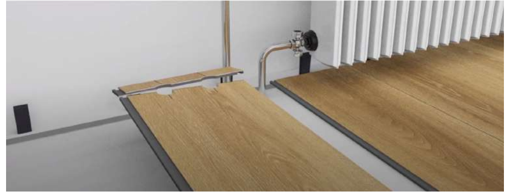
Tuberías: Mida el diámetro y perforo un agujero 12mm. más grande. Corte un trozo, y ponga la pieza recortada en su lugar. / Holes for pipes: Measure the diameter of the pipe and drill a hole that 12mm/1/2" larger. Saw a piece and lay the plank in place on the floor. Then lay the sawed piece in place.
